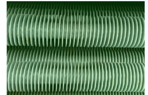
再熱器選用螺旋式鰭片換熱管 (間距8.5mm)，熱交換效率高
